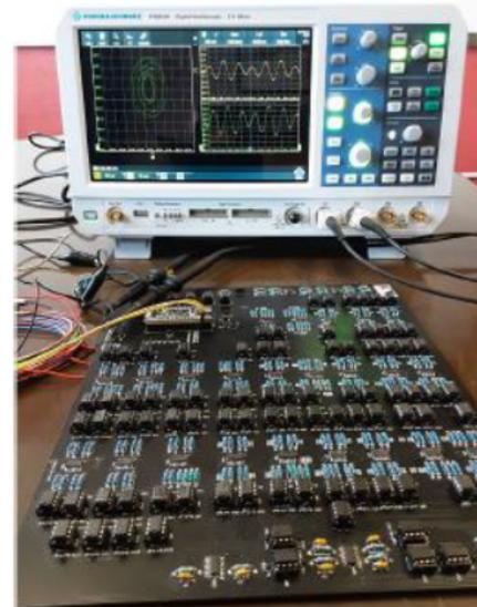
Izquierda: configuración geométrica de la cadena de 3 osciladores armónicos en 2D y (derecha) su realización experimental (sistema clásico con momento angular cero) mediante circuitos electrónicos [14].
